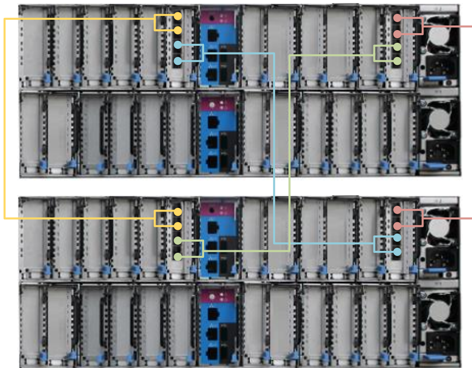
图 2-3 通过 NTB 卡连接-双端口线缆方式 1
