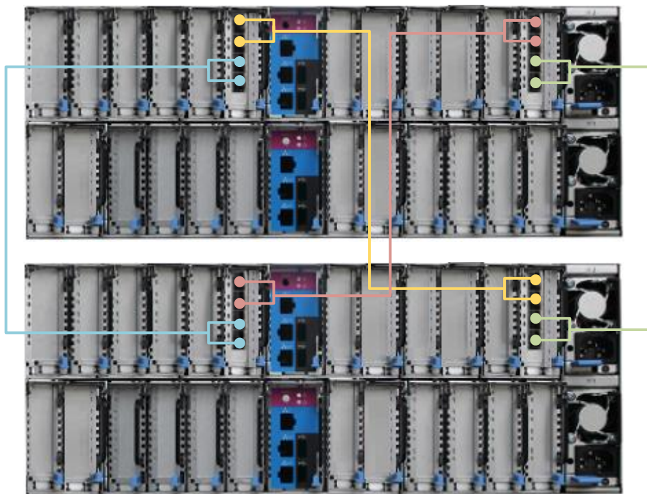
图 2-4 通过 NTB 卡四控连接-双端口线缆方式 2
